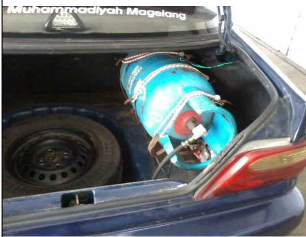
Gambar 5 Penempatan tabung gas pada mobil
