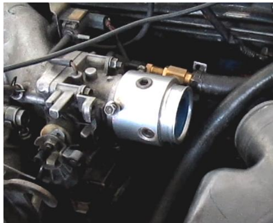
Gambar 3. Pemasangan mixer pada mesin
