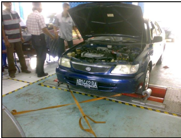
Gambar 7. Set up pada dynamometer
