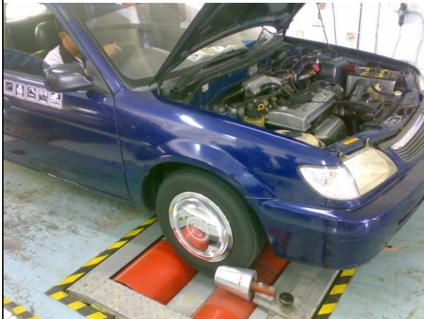
Gambar 9 Running pada dynamometer
