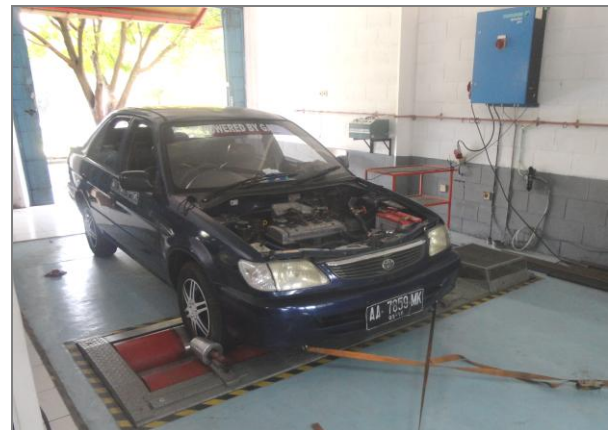
Gambar 4. Set Up Mesin pada dynamometer
