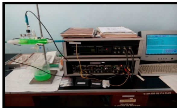
Gambar 2.3. Potensiostat PGS 201 T.
