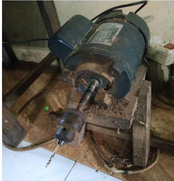
Gambar 6. Mesin Bor dari pompa bekas
