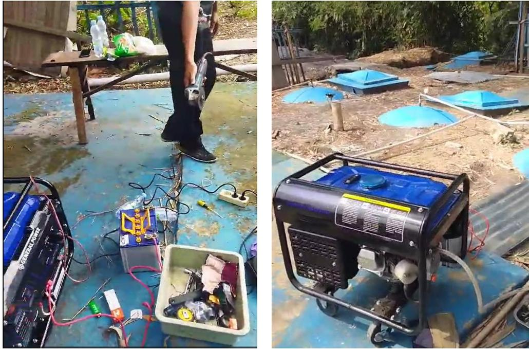
Gambar 3.3 Pengujian teknologi konversi biogas dengan dan tanpa beban listrik.
