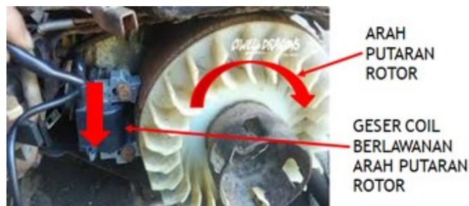
Gambar 6. Langkah Memasang coil dan menggeser 5 mm dengan arah berlawanan dengan arah putaran rotor
