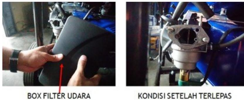
**Gambar 8.** Melepas box filter udara
