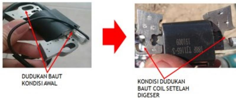
Gambar 5. Langkah menggeser lubang kedudukan baut pada coil pengapian
