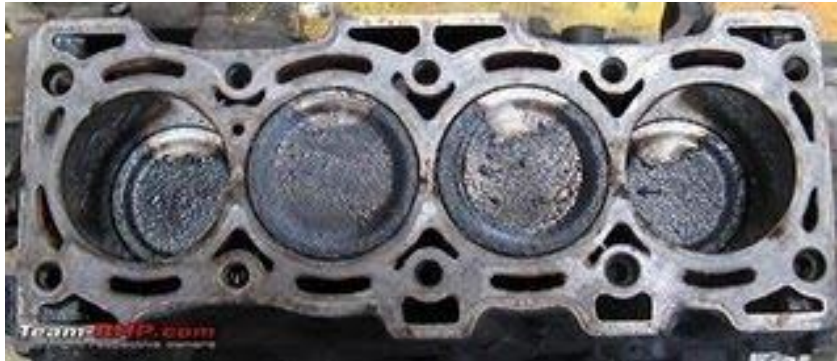
Gambar 2.3 Penumpukan kerak karbon pada piston
