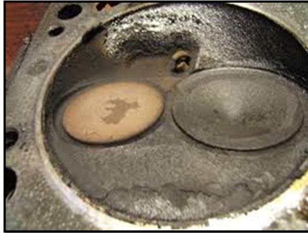
Gambar 1.2 Contoh penumpukan kerak karbon pada kepala silinder
