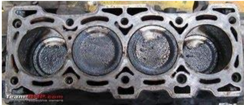
Gambar 2.3 Penumpukan kerak karbon pad piston
