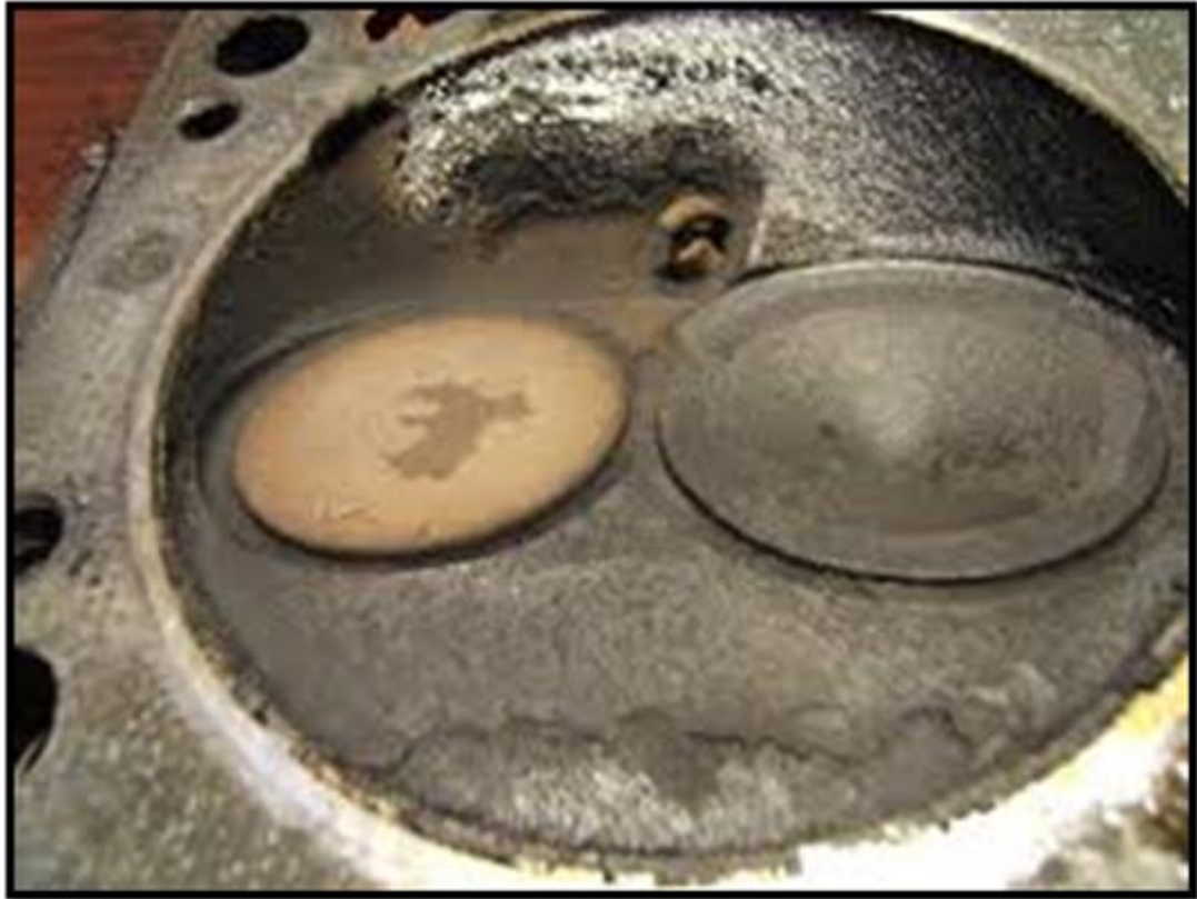
Gambar 1.2 Contoh penumpukan kerak karbon pada kepala silinder
