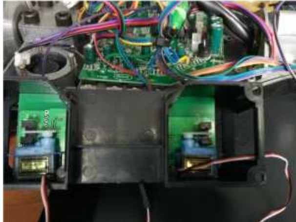
Gambar 4.5. kontrol photoelectric dengan motor servo
