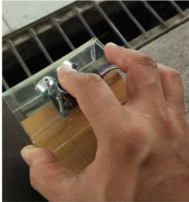
Gambar 4.6. Joystick digerakkan dengan jari untuk mengontrol kursi beroda
