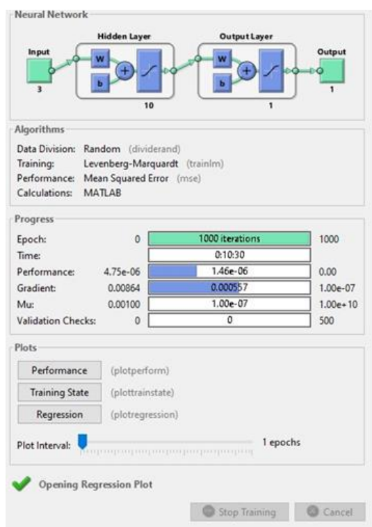
Gambar 4.8 Hasil validasi antara target dan pembelajaran (a) dan Arsitektur jaringan ANN dalam MATLAB Simulink (b).
